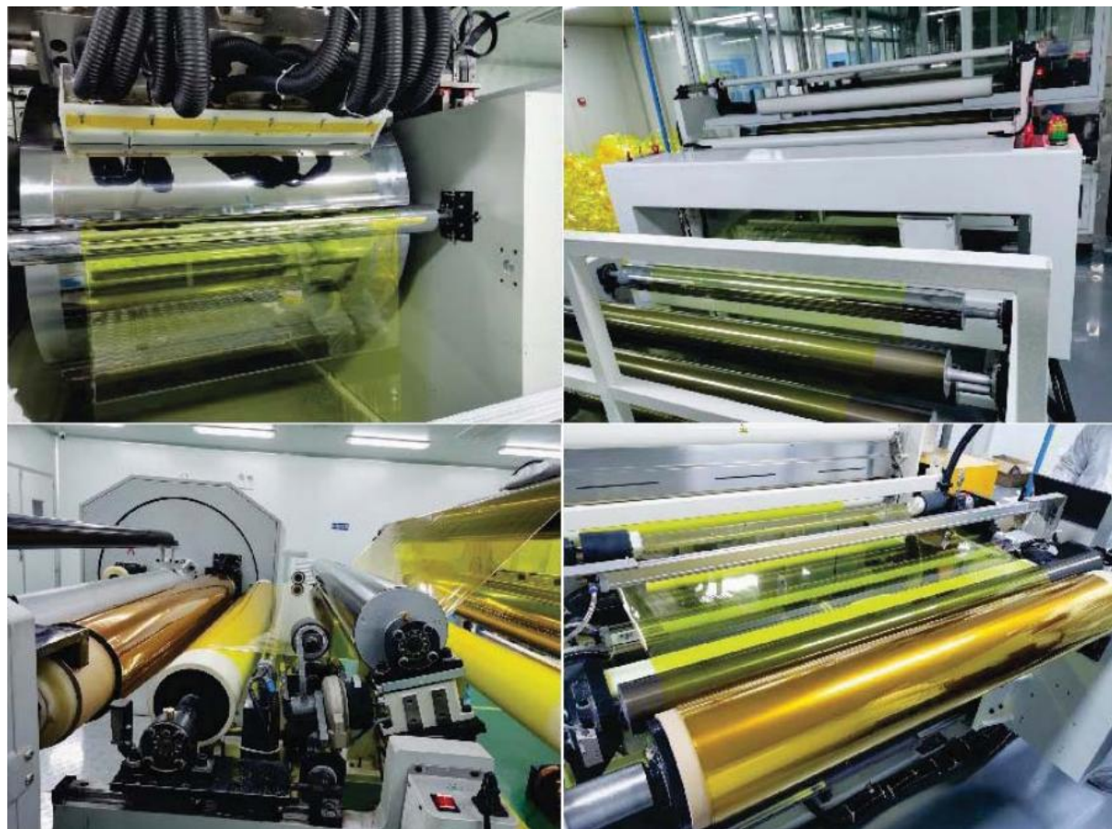
桂林电器科学研究院有限公司，1.6米幅宽双向拉伸聚酰亚胺薄膜生产线
